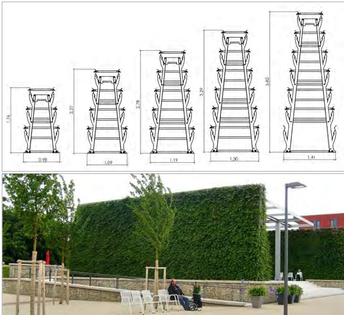
Slika 5. Primjer noseće konstrukcije prirodnog zida za zaštitu od buke i izvedenog stanja
